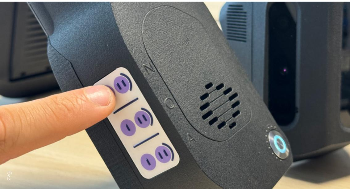
Les boutons de l'appareil NOA permettent d'activer des fonctionnalités IA telles que la description d'un objet ou d'un chemin d'accès à un bâtiment.
