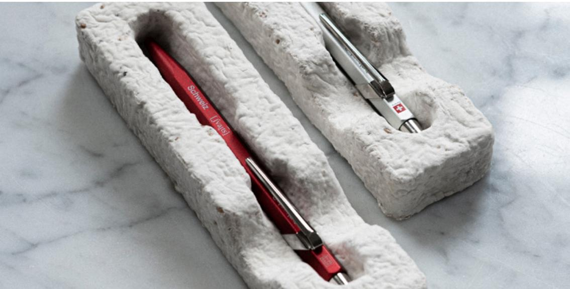
**Circulaire et fonctionnel : le composite de mycélium zéro déchet remplace les matériaux à base de pétrole dans la construction, l'aménagement intérieur ou, tel qu'illustré ici, comme solution d'emballage durable.**
